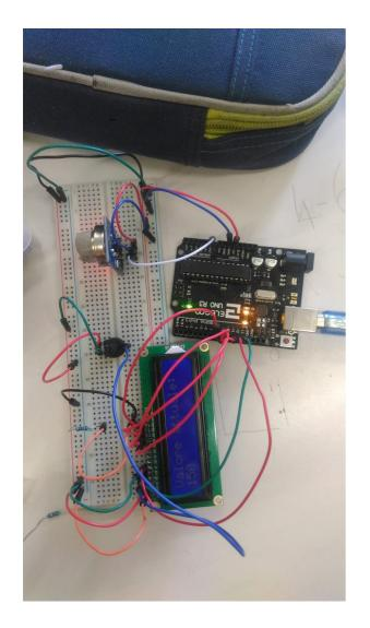
In questa fase abbiamo semplicemente applicato le conoscenze acquisite in materie come telecomunicazioni, sistemi e reti per poter realizzare il circuito del rilevatore di fumo. Nell' immagine si puo osservare il nostro circuito composto da un lcd che mostra i valori rilevati dal rilevatore di fumo, led un buzzer e una ventola che scattano appena viene superata il valore di soglia.
